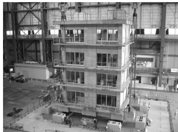
図1 実大鉄筋コンクリート造4層試験体
