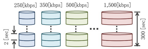
図7 蓄積映像ファイル (fragmented 3GP) 構成
