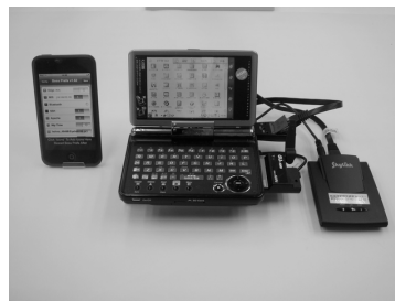
図 5 ε-ARK を用いたワイヤレスアクセスポイントの運用中の状況 (左: iPodTouch (アクセスポイントに接続中)、中: Zark、右: 無線 LAN アダプタ)
