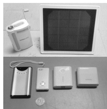
図 3 太陽電池充電装置 (上段右), 手回し式発電機 (上段左), Zark バッテリーセット 2 種 (下段左), 中間充電電池 2 種 (下段右)
