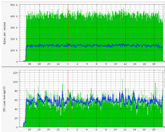
図 5 DoS 攻撃時の CPU/ネットワーク負荷 DoS 攻撃パケットに関してはネットワークが飽
